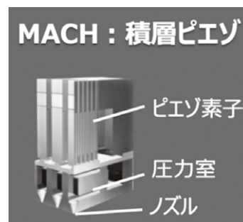
図5 MACHヘッドの構造図 （提供：セイコーエプソン株式会社）
